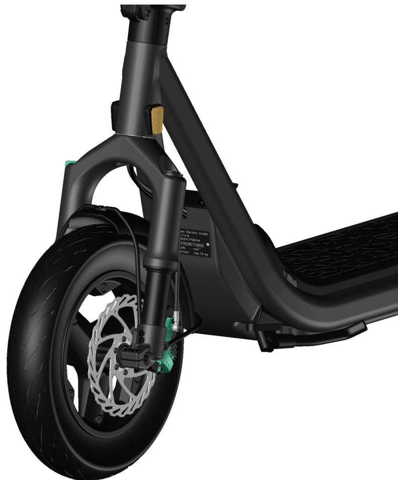
Geschafft! Der vordere Bremssattel ist nun wieder vollständig montiert und ausgerichtet.
